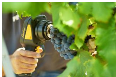
Les capteurs optiques de maturité au champ permettent une analyse non destructive. - © Pellenc
