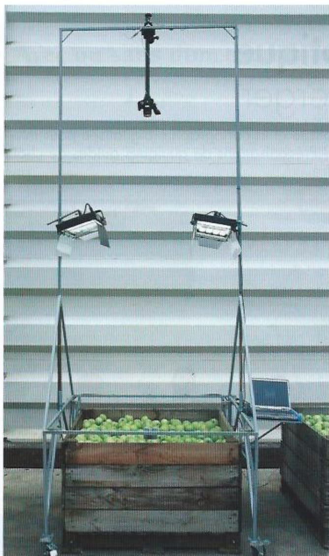
Pour le Pixfel du CTIFL, les photos du dessus du palox sont prises avec un appareil numérique du commerce de 8 megapixels minimum.
