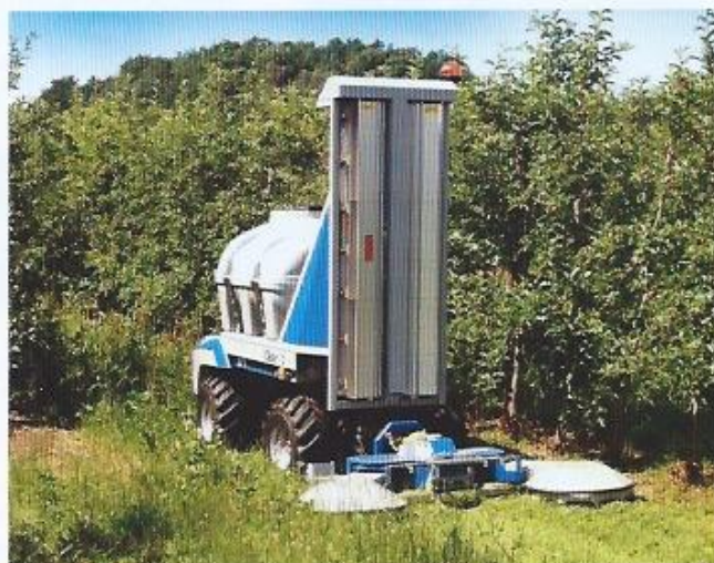
Le challenge est soit d'augmenter les vitesses d'exécution des robots, soit d'en associer plusieurs. La plateforme de pulvérisation Robot César de la firme allemande Raussendorf n'avance pas très vite mais a le mérite de réaliser des opérations simultanées : pulvériser et couper l'herbe.
